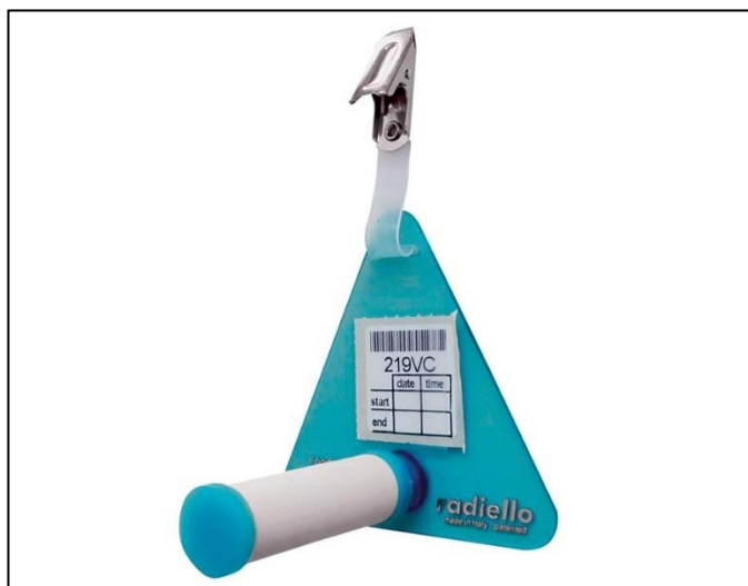
Figur 5. En passiv luftmätare av märket Radiello.
