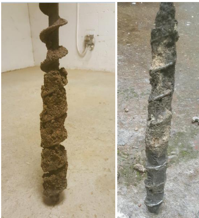
Figur 7. Exempel på ytliga (0-1 m) fyllnadsmassor inom undersökningsområdet, till vänster Skr 1709 som är belägen i den södra byggnaden och till höger Skr 1705 som är belägen inom den östra delen av innergården.
