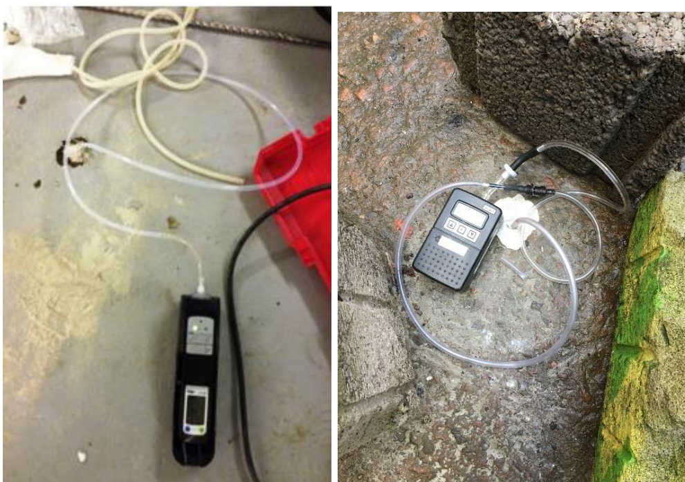
Figur 6. Till vänster läckagekontroll med hjälp av gasmätare (punkt 1703) och till höger porgasprovtagning med lågflödespump och kolrör (punkt 1704).
